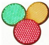
Opticas LED de 200 y 300 mm, con 100 led de alta potencia. Conectados individualmente o en Serie según Requerimientos. Funcionan a 220-24-12 Volt. Reemplazo Directo gracias a su Soporte Stanco Incluido.
