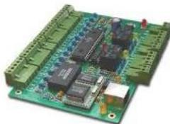
Controladora Ip de Manejo Central de Semáforos. Permite Sincronismo de Onda Verde. Variación de Tiempo según Demanda Vehicular. Permite encadenar hasta 250 semáforos. Funciona a 220 - 24 - 12 Volt. Sincronismo con GPS. GPRS - WIFI - RF
